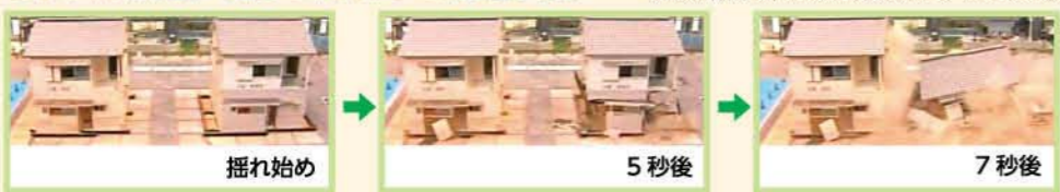
1981年の建築基準法改正前に建てられた耐震性能の低い建物。左側の家屋には耐震補強を施しています。
